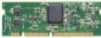
Şekil 6.5. F28335 Delfino işlemcinin görünümü.
