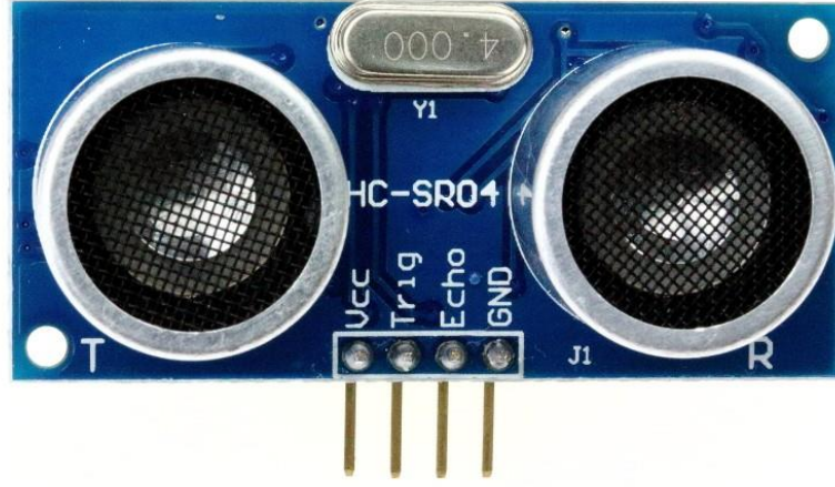
Şekil 2.16. HC-SR04 ultrasonik sensörün pinleri [22].
