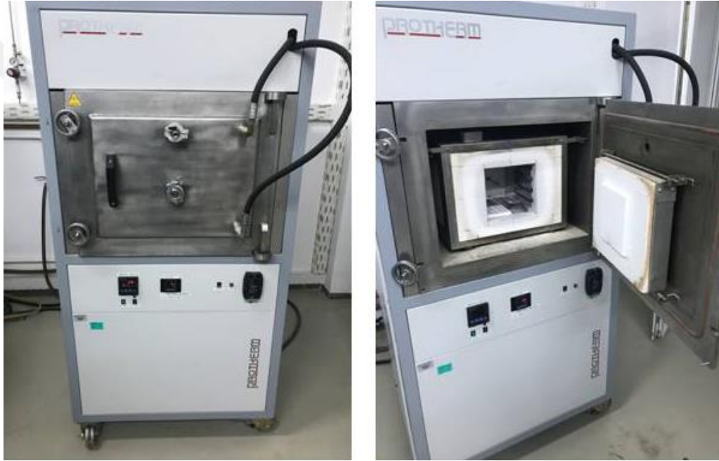
Şekil 7.2. Protherm ACF 110/6 yaşlandırma fırını.
