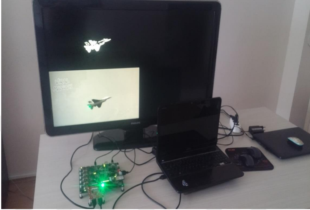
Şekil 7.1. ZC702 deneme kartının önerilen yöntemin 2x2 blok tabanlı gerçekleştirilmesinin görsel sonucu.
