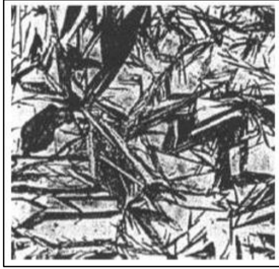
Şekil 4.2. Martenzit yapı mikroyapı görüntüsü [18].
