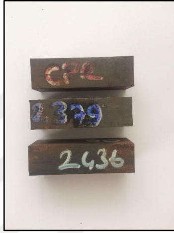
Şekil 5.10. Deneylerde kullanılan 3 tip soğuk iş takım çeliği numuneleri
