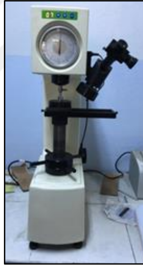
Şekil 5.13. Rockwell sertlik cihazı.
