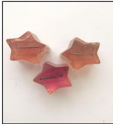
Şekil 5.11. Bakalite alınan soğuk iş takım çelikleri.
