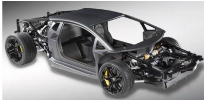
Şekil 4.23. Karbon fiber monokok şasi.
