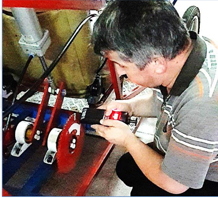
Şekil 6.10. Motor devrinin ölçülmesi.
