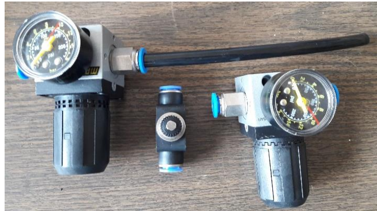
Şekil 6.4. Basınç ayar regülatörü ve hız ayar vanası.
