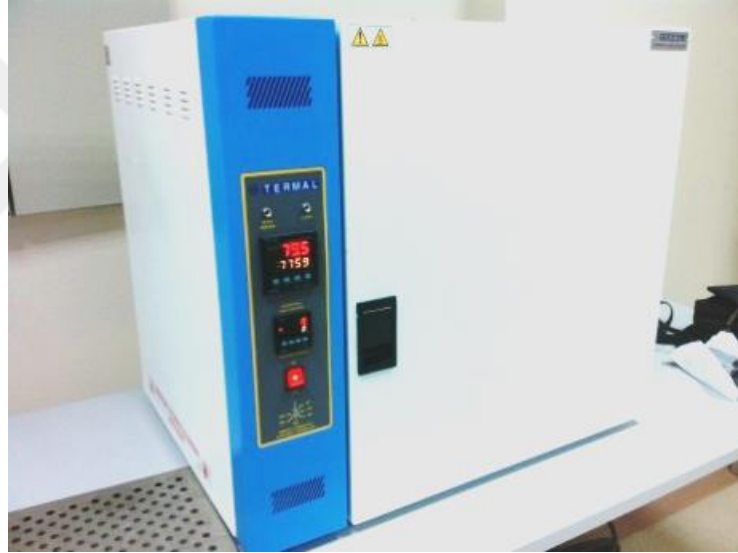
Şekil 4.4. Temperleme işleminin uygulandığı Termal marka ısıl işlem fırınının görüntüsü.
