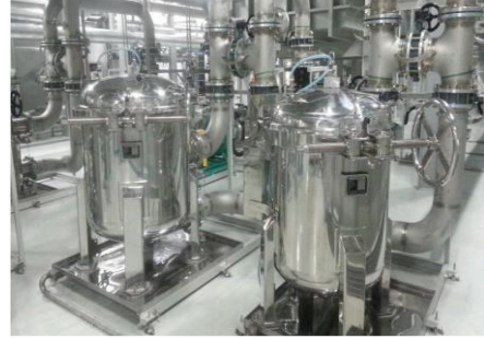
Şekil 3. 12. Boya filtrasyonu orensip resmi.
