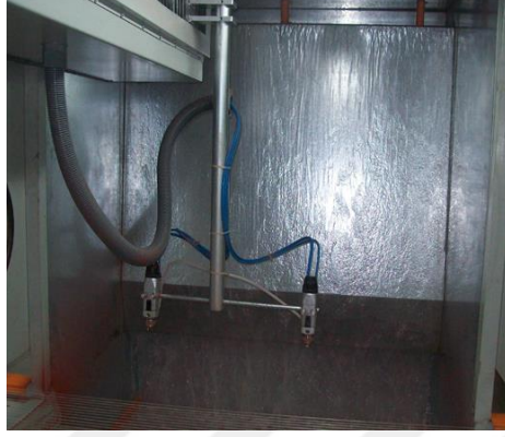
Şekil 4. 5. Su perdeli yaş boya kabini prensip resmi.
