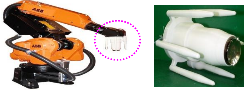
Şekil 4. 3. Elektrostatik disk tipi püskürtme uygulaması.
