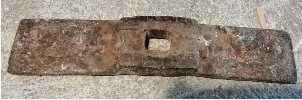
c) Baltacık, üst değirmen taşının altına yerleştirilen ve çarka bağlı milin üst değirmen taşına bağlanmasına yarayan parça.
