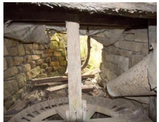
f) Çarkın dönme enerjisinin üst değirmen taşına ileten düşey mil.
