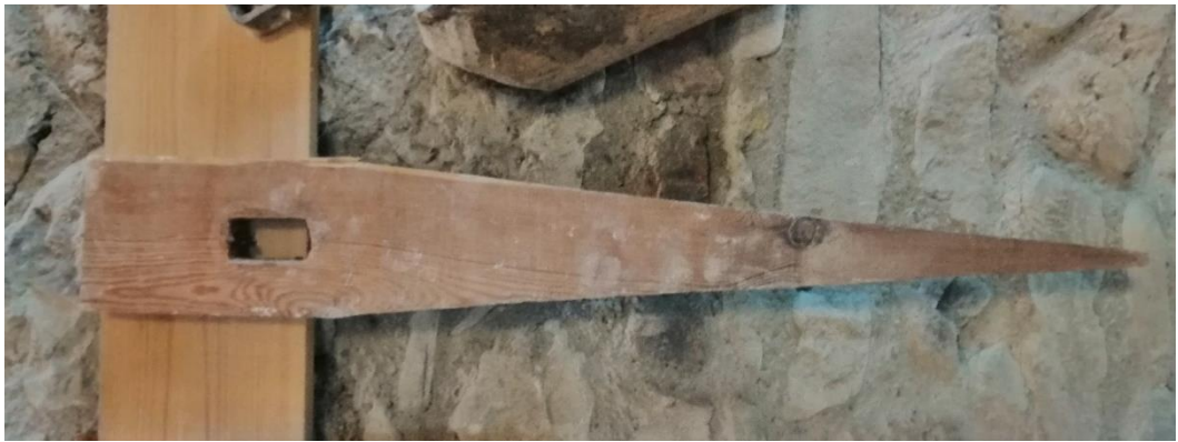
Şekil 3.6. Pergel; Alt değirmen taşının üstünden, boşluk kısmı mile geçirilerek, taşın eğimini kontrol etmeye yarayan alet.
