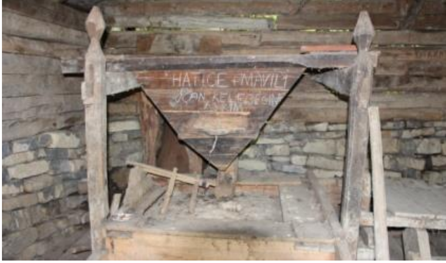
a) Değirmen düzeneği tekne ve üst değirmen taşı.
