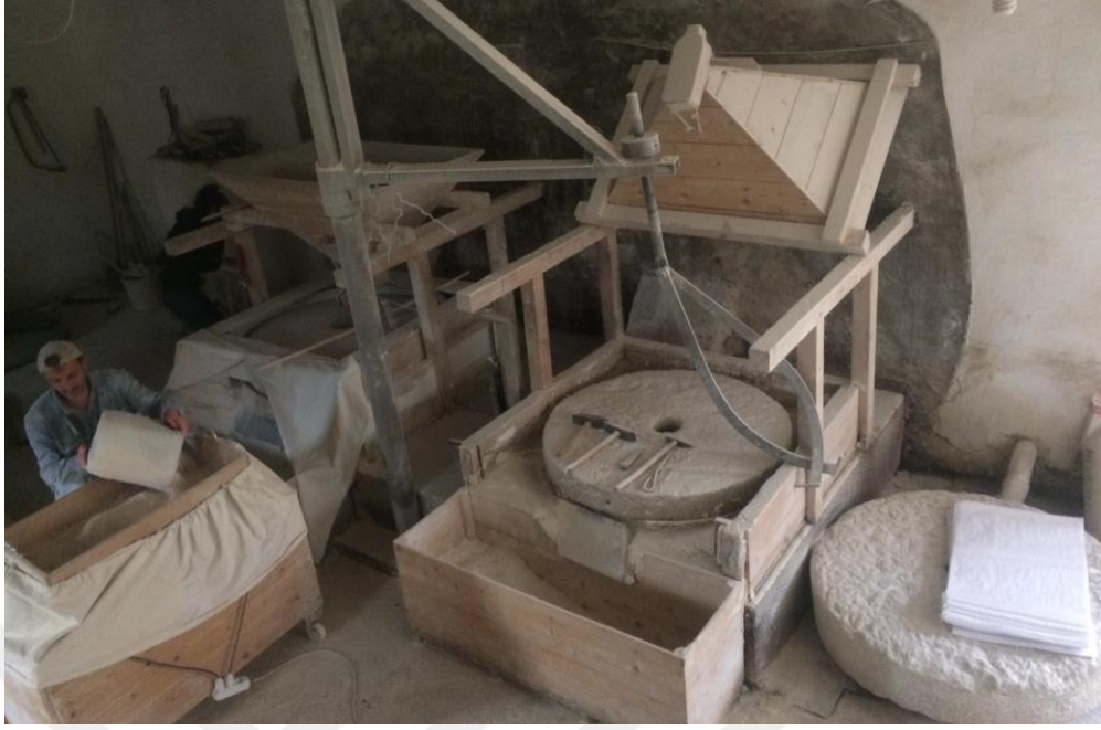
a) Su değirmeni olarak çalıştırılmaya devam edilen Karıt Değirmeni değirmen düzenekleri
