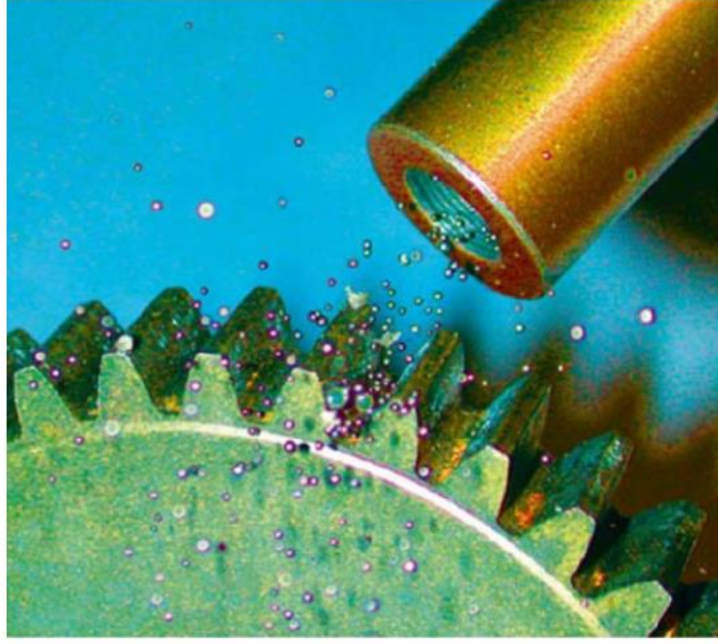
Şekil 2.1. Bir dişlinin dişlerinin bilyalı dövülmesi [19].
