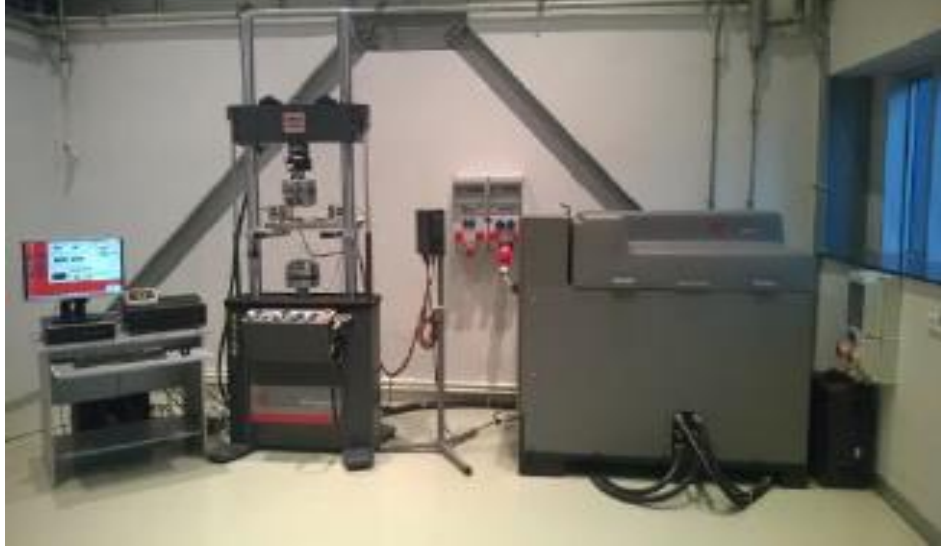
Şekil 3.5 Servohidrolik dinamik test cihazı.
