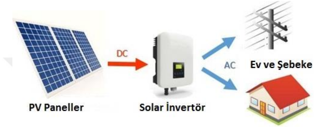
Şekil 4.3. Şebeke bağlı fotovoltaik sistemin şeması [31].
