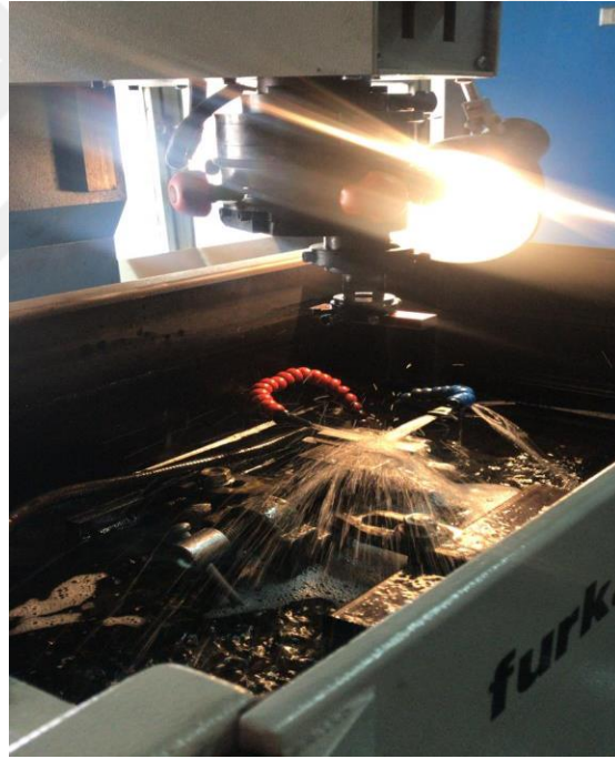
Şekil 4.4. İş parçasının dielektrik sıvı ile ıslatılması.
