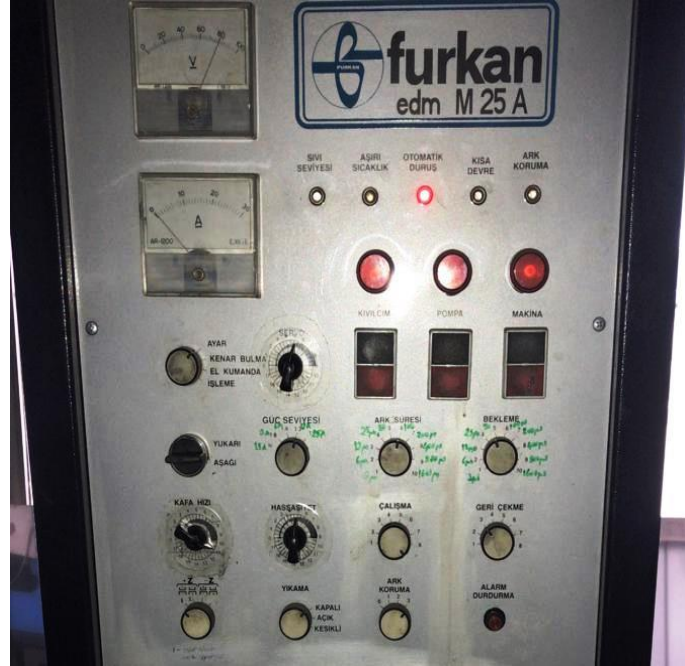
Şekil 4.3. Tezgâh kontrol panosu.
