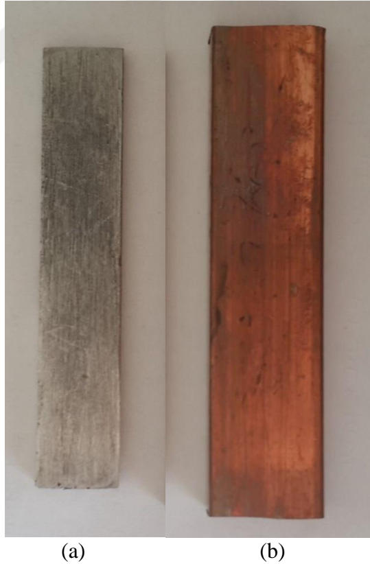
Şekil 4.1. Deney numuneleri; (a) iş parçası, (b) elektrot.
