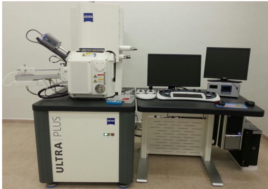
Şekil 5.9. Carl Zeiss Ultra Plus Gemini Fesem SEM analiz cihazı.
