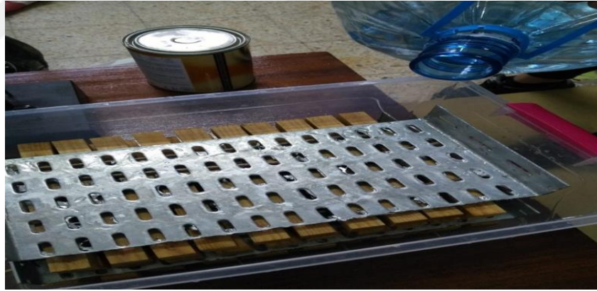
Şekil 3.3. Deney örneklerinin su alma oranının belirlenmesi.
