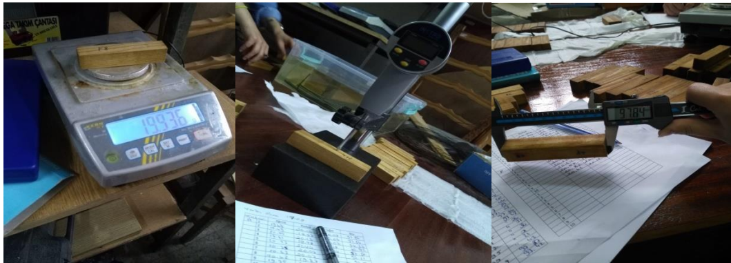
Şekil 3. 2. Deney örneklerinin ağırlık ve boyutlarının ölçümü.
