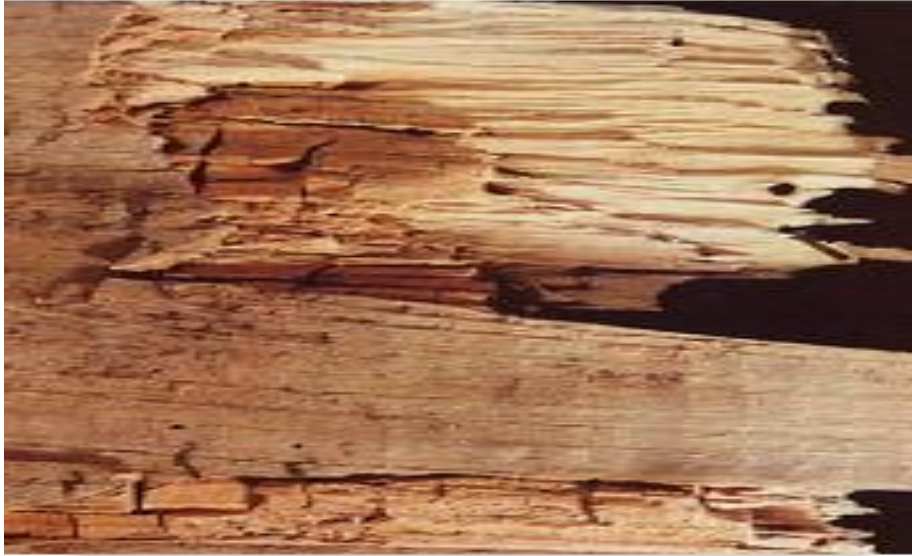
Şekil 2.6. Biyolojik bozunma sonucu çürümeye maruz kalmış ahşap ( http://tuzker.com.tr/ahsabin-dusmanlari/ ).
