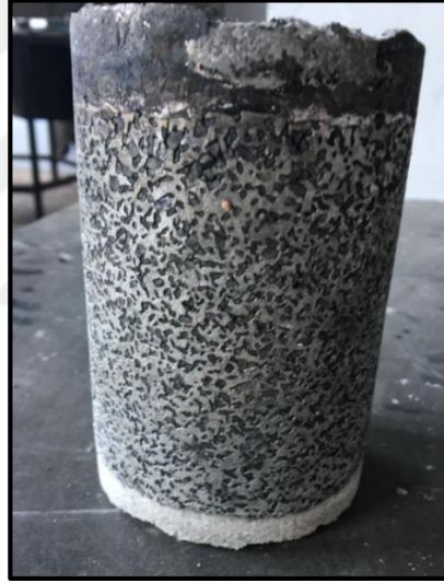
Şekil 4.5. İnfiltrasyon işlemi sonrasında kalıptan çıkartılmış ve şekillendirilmemiş haldeki kompozit blok.
