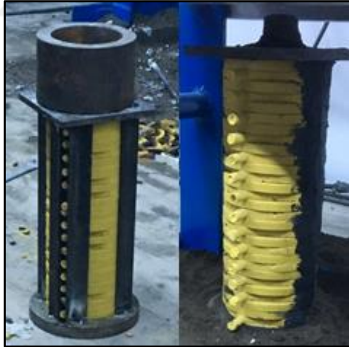
Şekil 4.14. Shell maça kumu yer tutucuların üst üste dizilmesi.
