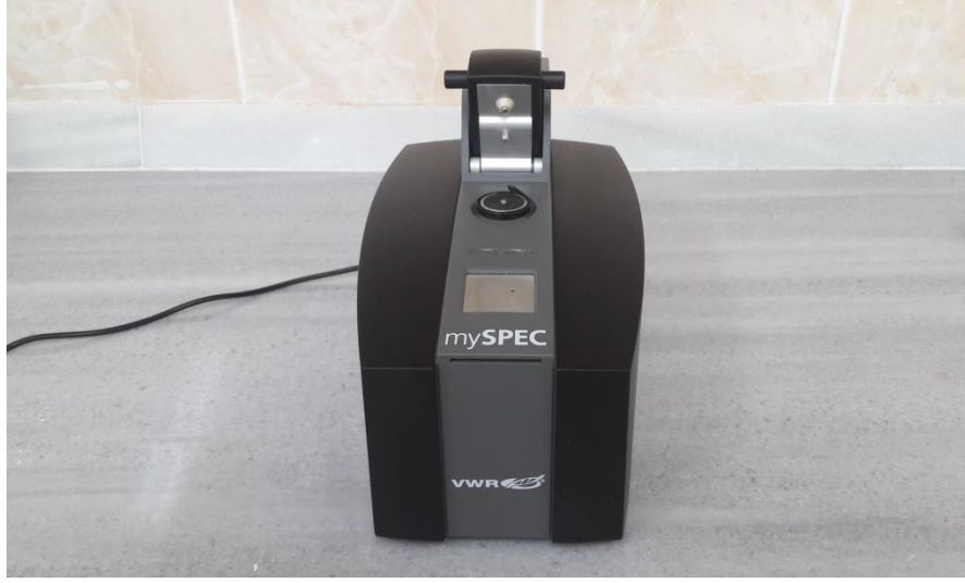
Resim 2: Çalışmada kullanılan nükleik asit ölçer 260/280 nm UV spektrofotometre cihazı
