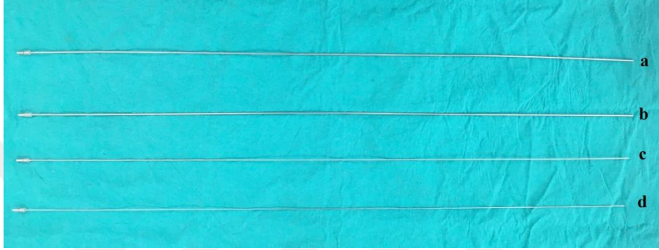
Resim 6. Farklı çap ve 120 cm boyundaki proplar. a- 5 mm çaplı prob, b- 4 mm çaplı prob, c- 3 mm çaplı prob, d- 2 mm çaplı prob
