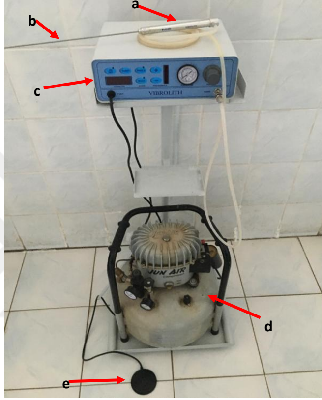
Resim 4: Pnömatik litotoripsi cihazının kullanıma hazır haldeki görüntüsü a- Elcek, b- Prob, c- Vibrolith, d- Basınçlı hava kompresörü, e- Pnömatik ayak pedalı
