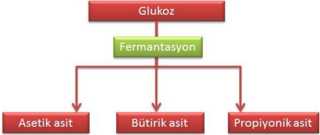
Şekil 2.2. Glukozun fermantasyonu sonucu UYA'lerine dönüşmesi (Akgül 2014).
