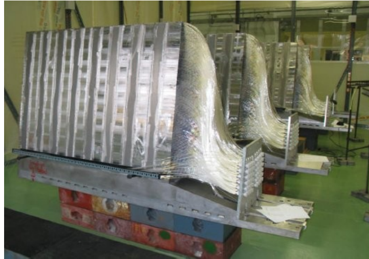
Şekil 5 : Kuvars fiberli HF takozların montajı
