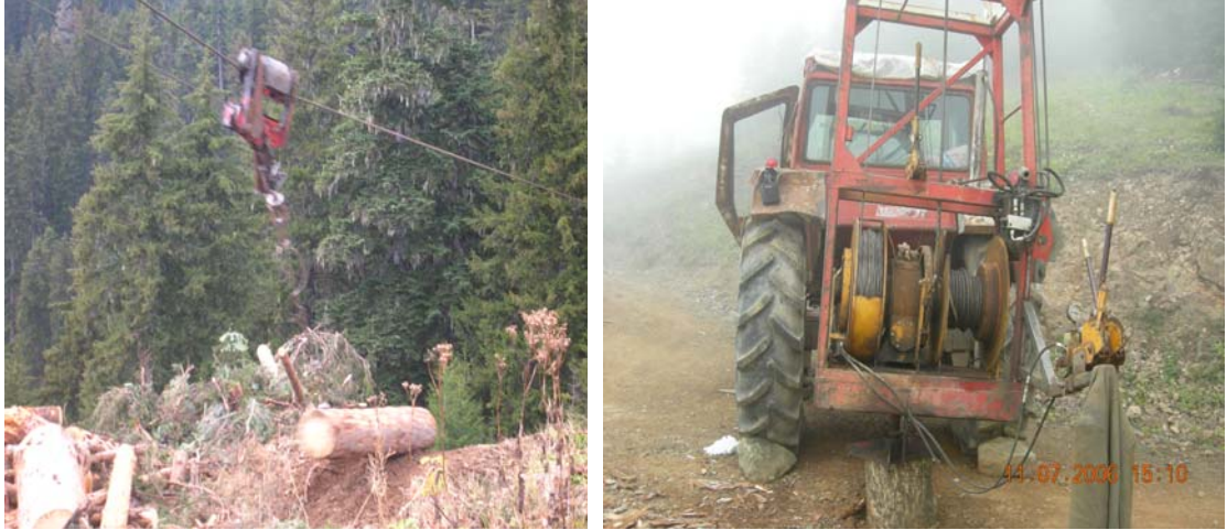
Resim 3.1: Traktöre Monteli Koller K300 Vinçli Hava Hattı İle Bölmeden Çıkarma
