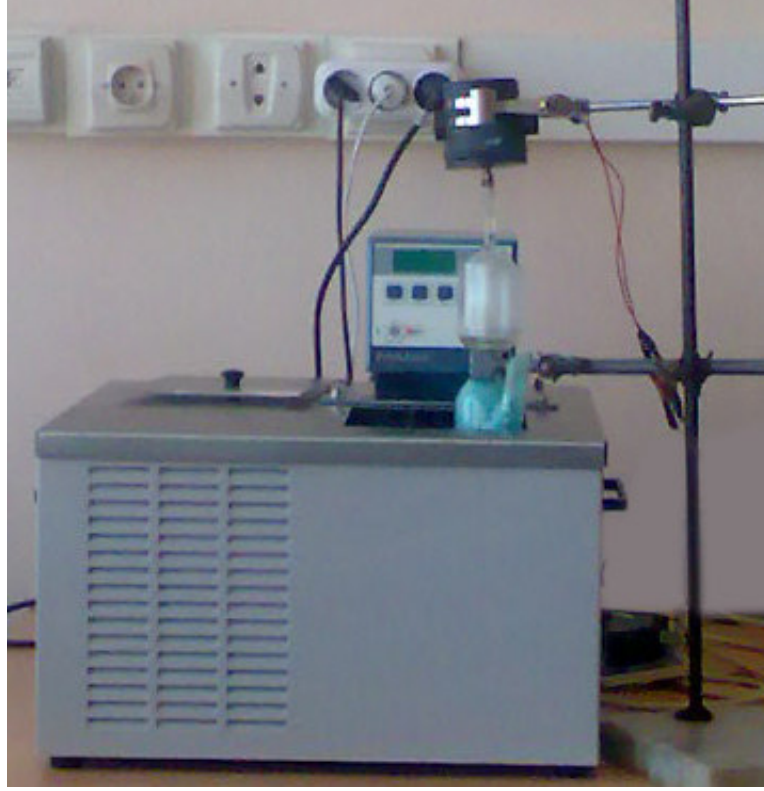
Şekil 1. Su-Tuz Sisteminin İzotermal Yöntemle Araştırılması İçin Kullanılan Düzenek.
