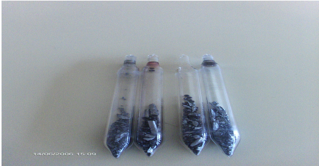
Resim 4.2: GaSe bileşiminin sentezi için gerekli oranda Ga ve Se doldurularak vakumlanmış kuartz tüpler
