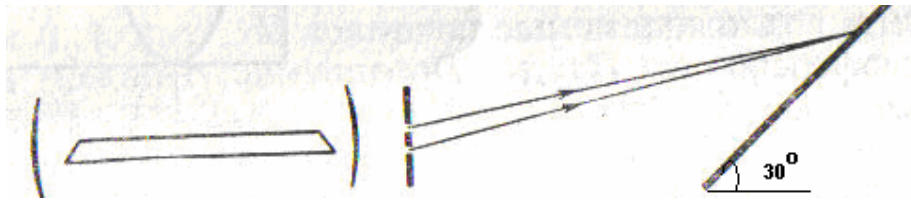
Şekil1.1.3. Lazer ışığıyla iki yarıktan girişimin incelenmesi[2].
