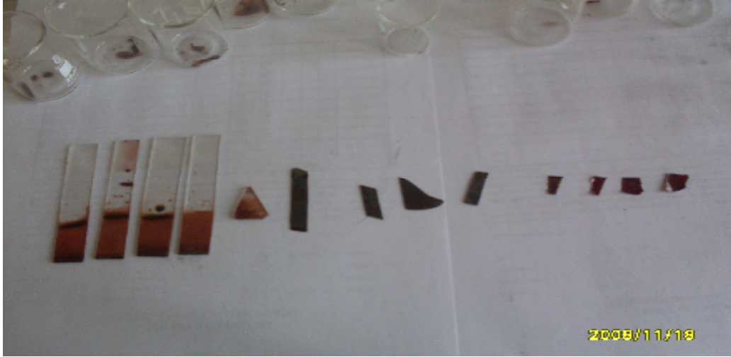
Resim 4.3.4.1 4 adet mikroskop camı, 1 adet iletken cam, 4 adet Si ve 4 GaSe (0,01Ge katkı) üzerine büyütülmüş MoSe 2 ince filmleri.
