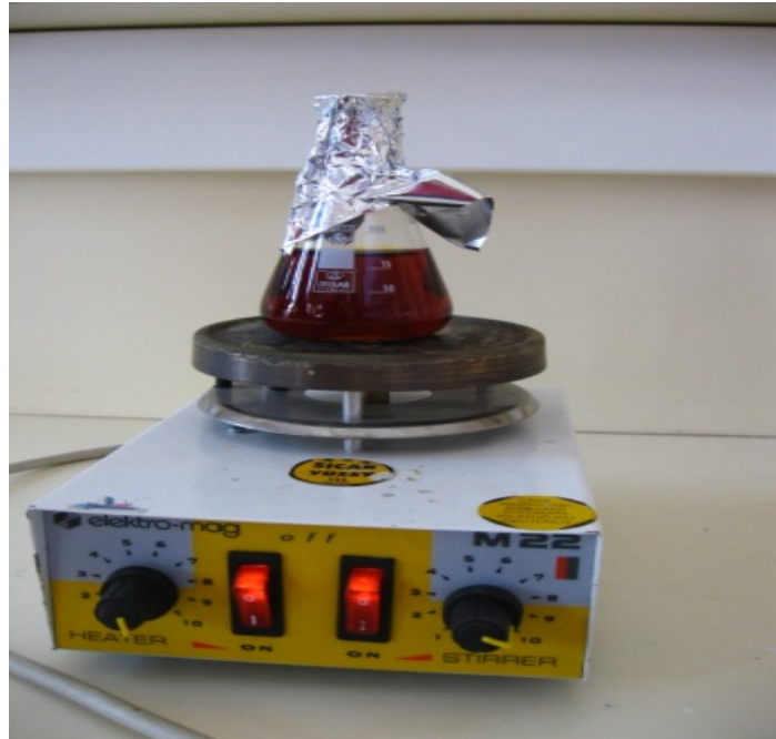
Resim 4.3.1.6 Elektromanyetik karıştırıcı ile çözeltinin karıştırılması.
