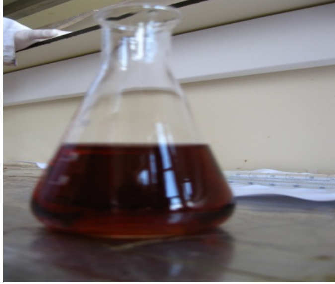
Resim 4.3.1.5 10 ml'lik amonyum molibden çözeltisi, 5 ml'lik tartarik asit çözeltisi, 10 ml'lik hidrazin hidrat çözeltisi, sodyum selenosülfat çözeltisi ve 35 ml'lik saf suyun karışımı.
