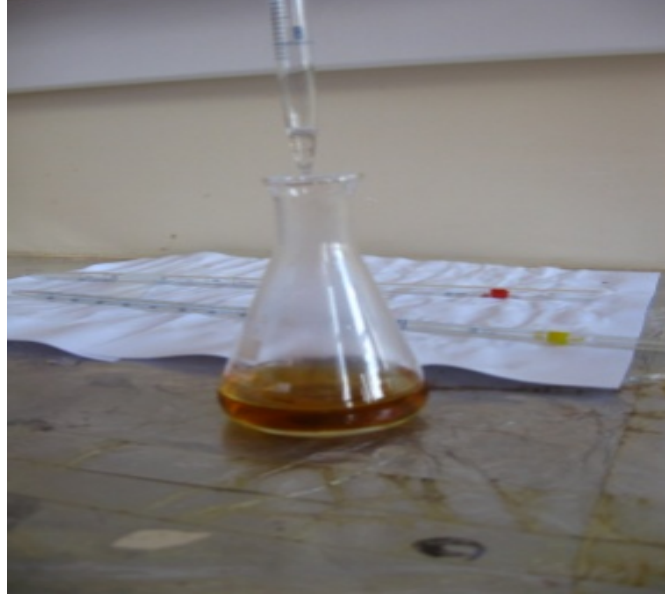
Resim 4.3.1.3 10 ml'lik amonyum molibden çözeltisi, 5 ml'lik tartarik asit çözeltisi ve 10 ml'lik hidrazin hidrat çözeltisinin karışımı.
