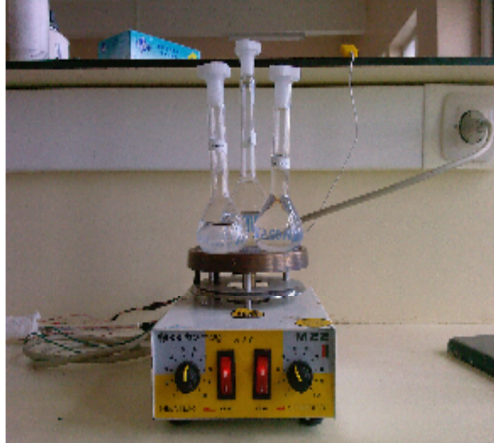
Resim 4.3.1 Elektromagnetik ısıtıcı üzerinde çözeltilerin çözünmesi.
