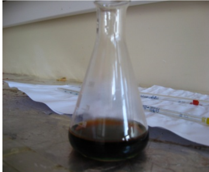
Resim 4.3.1.4 10 ml'lik amonyum molibden çözeltisi, 5 ml'lik tartarik asit çözeltisi, 10 ml'lik hidrazin hidrat çözeltisi ve 20 ml'lik sodyum selenosülfat çözeltisinin karışımı
