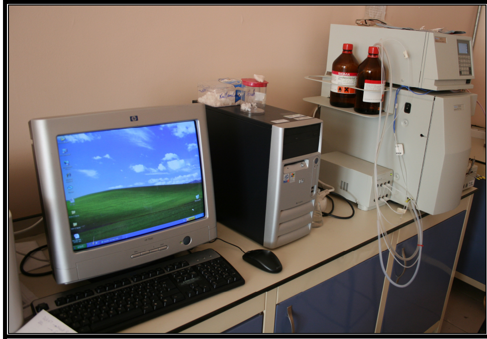
Resim 3.1. Kullanılan Waters marka GPC cihazı ve sistemi.
