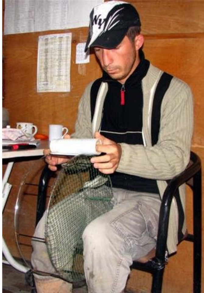
Resim 3.4 Busse deney kafesinin streç film ile sarılması
