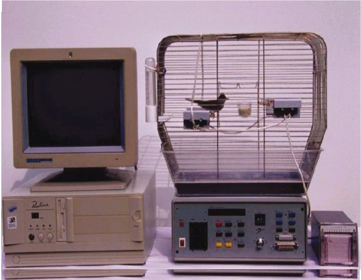
Resim 2.1. İçinde tünekler olan ve elektrikli bir sayaç ile kuşların bu tüneklere zıplama miktarlarının ölçülerek göç huzursuzluğunun (zugunruhe) belirlenmesini sağlayan cihaz
