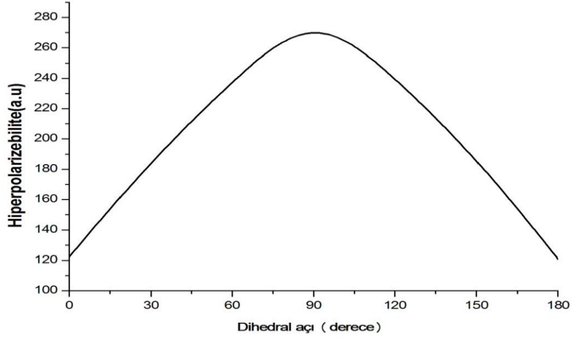
Şekil 4.27 HF/6-311++G(d,p) modeli ile hesaplanan 3-(4-klorofenil)tiyofen molekülünün hiperpolarizebilitesinin dihedral açđya bađlı olarak deđişimi
