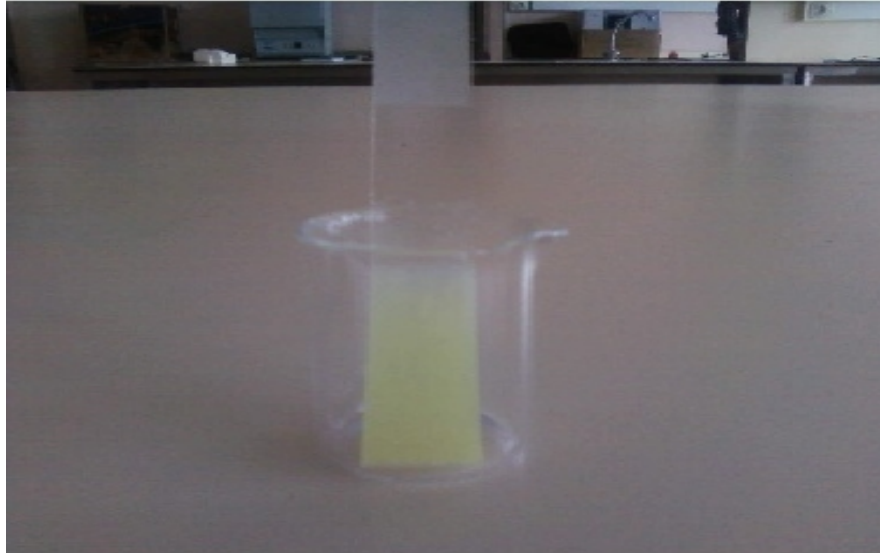
Resim 5.3 Daldırma sonucunda cam alt taban üzerinde büyütülen GaS ince filmi
