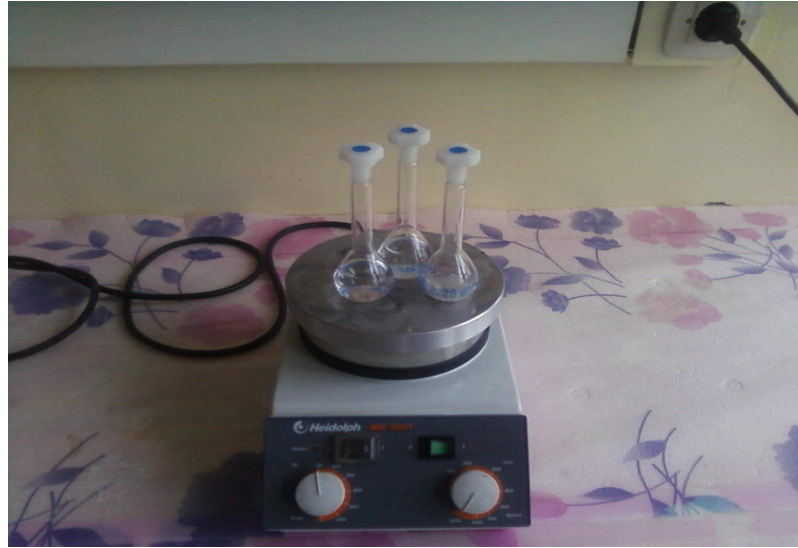
Resim 5.1 Elektromagnetik ısıtıcı ve titreştirici üzerinde çözeltilerin çözünmesi
