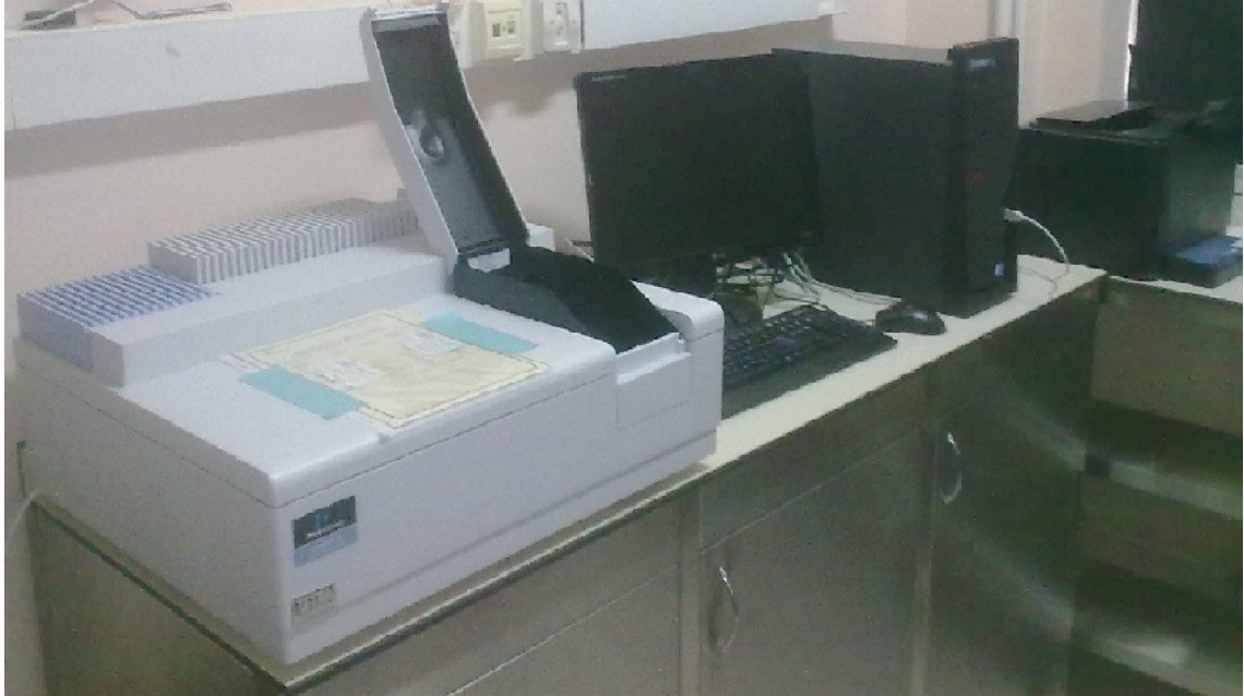
Resim 5.4 Perkin Elmer marka UV-VIS Lambda 25 model spektrofotometre sistemi
