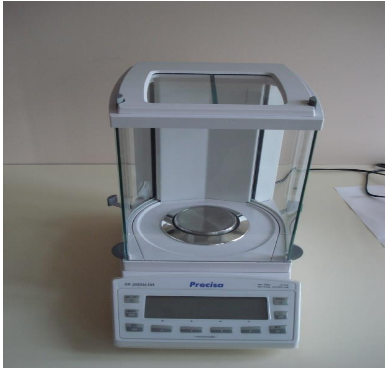
Resim 4.1.2. Yoğunluk ve kimyasal dayanıklılık testlerinde kullanılan hassas terazi.
