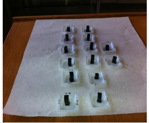
Resim 4.3.1. Cam kesme-parlatma sistemi ve kimyasal dayanıklılık için hazırlanan numuneler.
