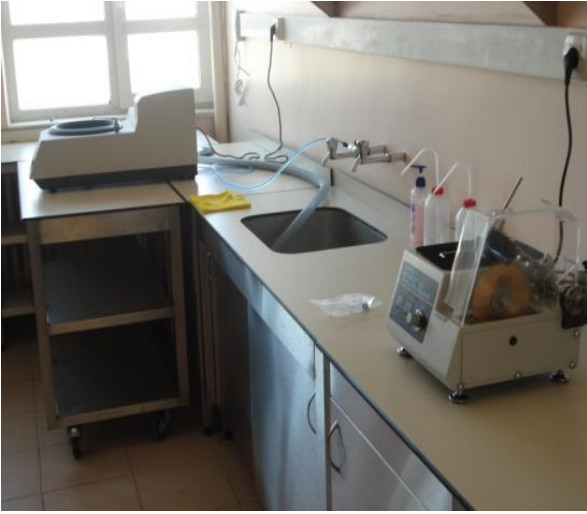
Resim 4.3.1. Cam kesme-parlatma sistemi ve kimyasal dayanıklılık için hazırlanan numuneler.
