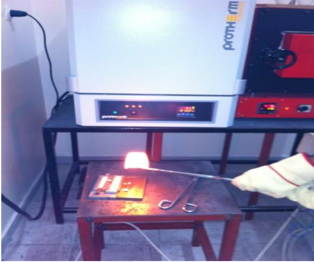
Resim 4.1.3. Camları eritmek ve tavlamak için kullanılan fırınlar (Kafkas Üniversitesi Malzeme Hazırlama Laboratuvarı).
