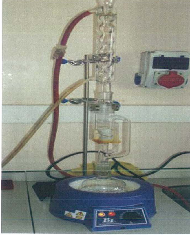
Resim 2.1. Deneysel çalışmada kullanılan soxhlet ekstraksiyonu sistemi
