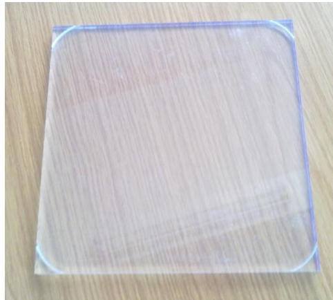
Şekil 3.7. Sintilatör detektörü yapımı için kullandığımız sintilatör karosu
