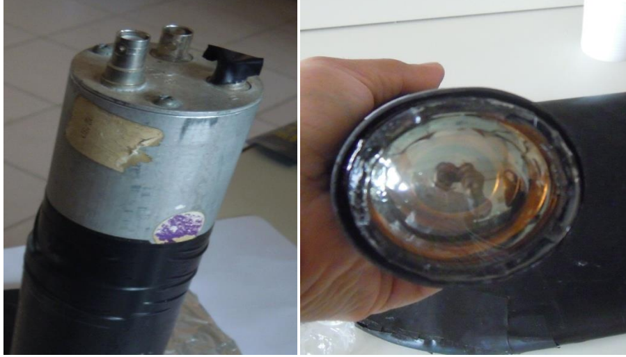
Şekil 3.11 Detektörlerde kullandığımız yüksek voltajlı foto çoğaltıcı tüp
