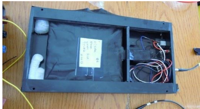
Şekil 3.6 Düşük voltajlı foto çoğaltıcı tüp kullandığımız detektörün açık şekli
