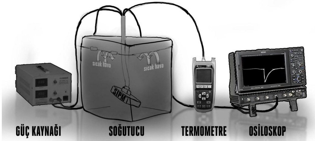
Őekil 4.1 Sensel30035FM SiPM kazanç karakterinin arařtırıldıđı deney dzeneđi
