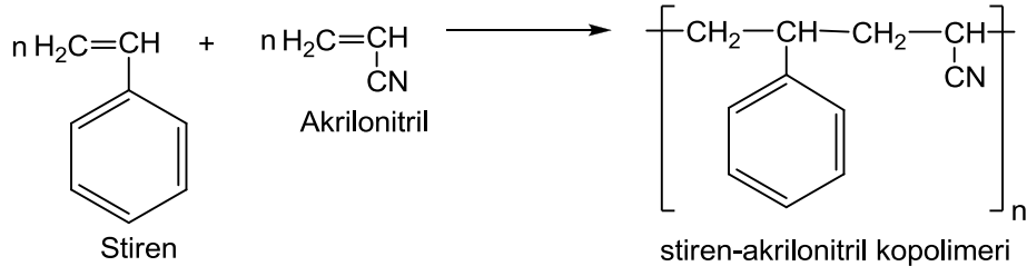
Şekil 2. Stiren ve akrilonitril'in kopolimerizasyonu.
