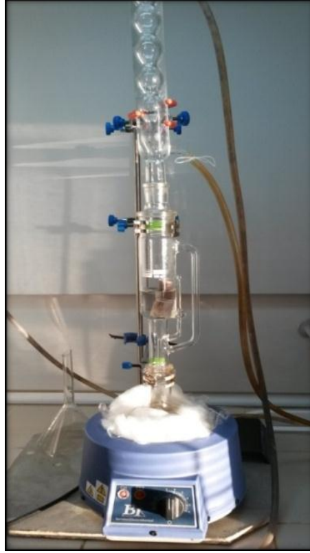
Şekil 7. Soxhlet Ekstraksiyon Düzenegi
