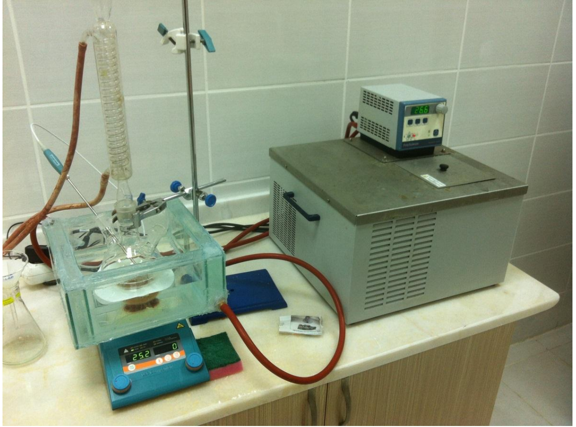
Şekil 2.2. Chevrel Tuzunun Çözündürülmesi İşlemlerinde Kullanılan Deney Sistemi
