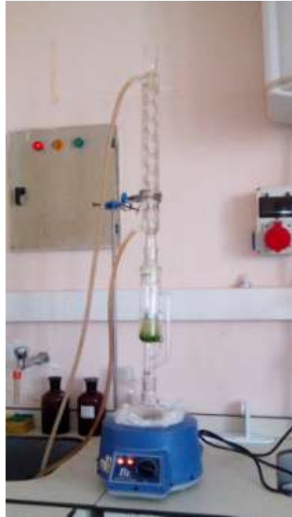
Resim 2.1. Deneysel çalışmada kullanılan Soxhlet ekstraksiyonu sistemi
