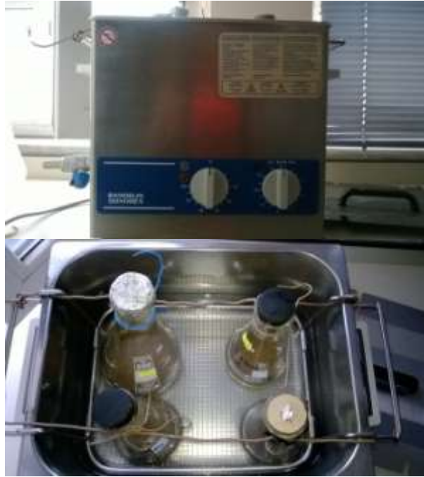
Resim 2.2. Deneysel çalışmada kullanılan ultrasonik banyo ekstraksiyon sistemi
