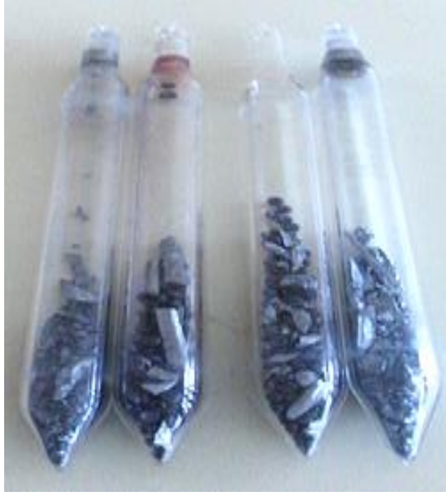
Resim 3.3: Büyütülecek elementlerin belirli oranlarda doldurulup vakum ortamında kapatıldığı kuartz ampuller.
