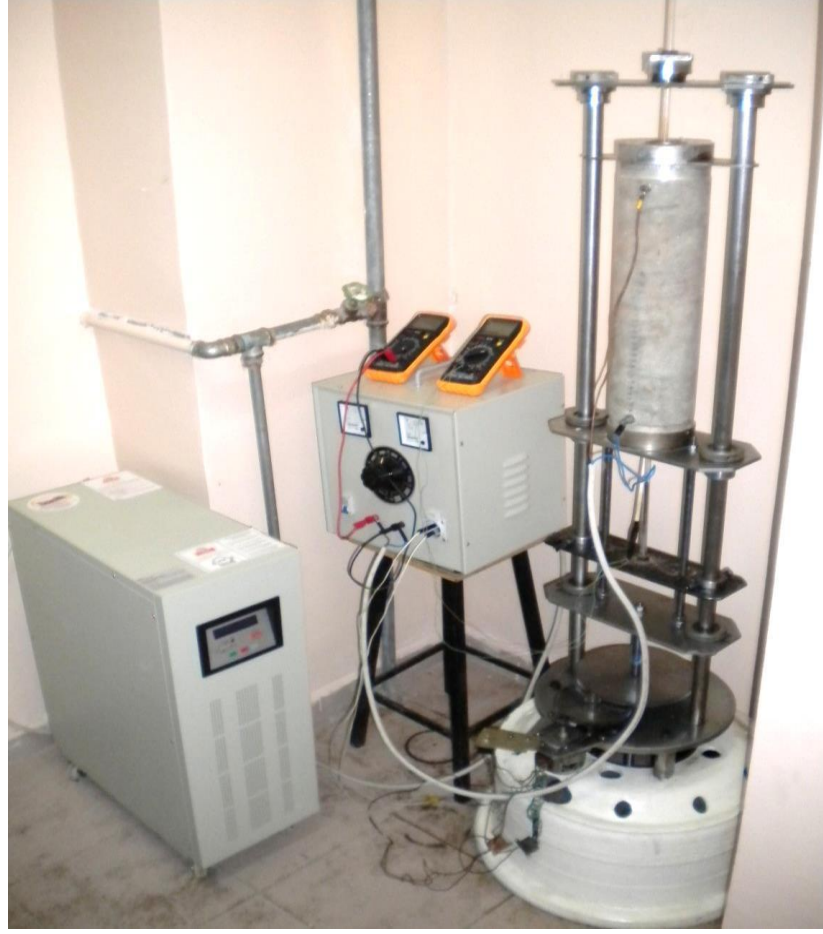
Resim 3.1: Bölümümüzde kurduğumuz Bridgman kristal büyütme sistemi.
