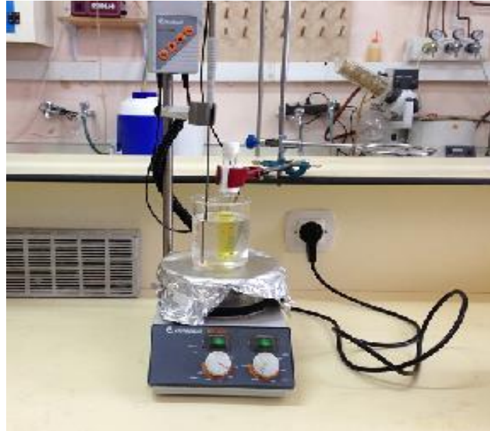
Şekil 64. Poli(akriloil klorür-graft-kaprolakton) graft kopolimerin deney düzeneği fotoğrafı
