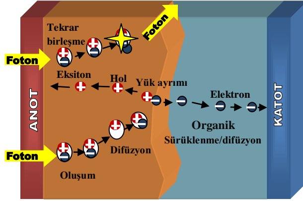
Şekil.17 Organik Güneş Hücrelerinin Çalışma Prensibi
