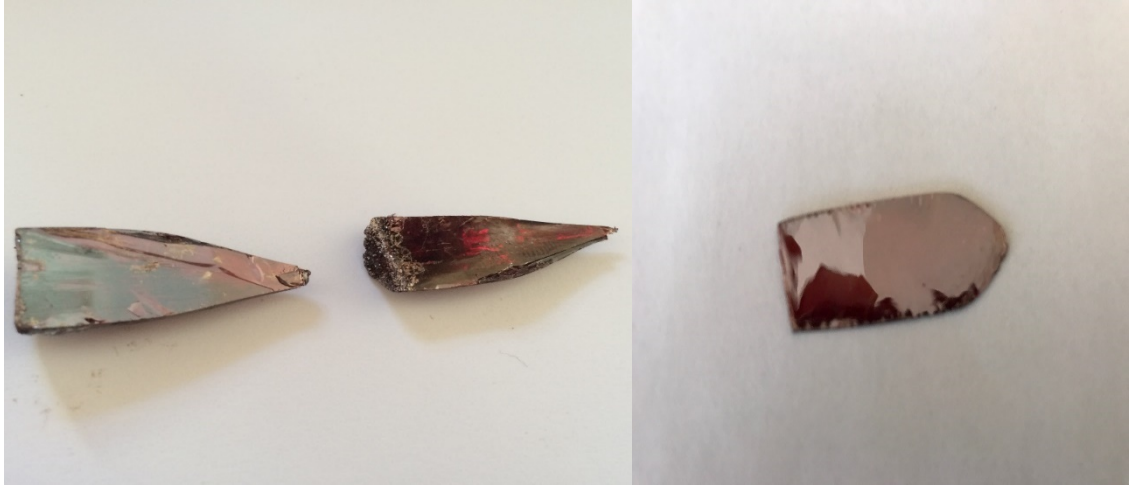
Resim 3.3: Dikey Bridgman yöntemi ile büyütölen GaSe kristalleri.
