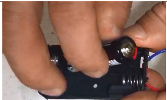
Şekil 2.4.3. Birinci Pilin Yerleştirilmesi
