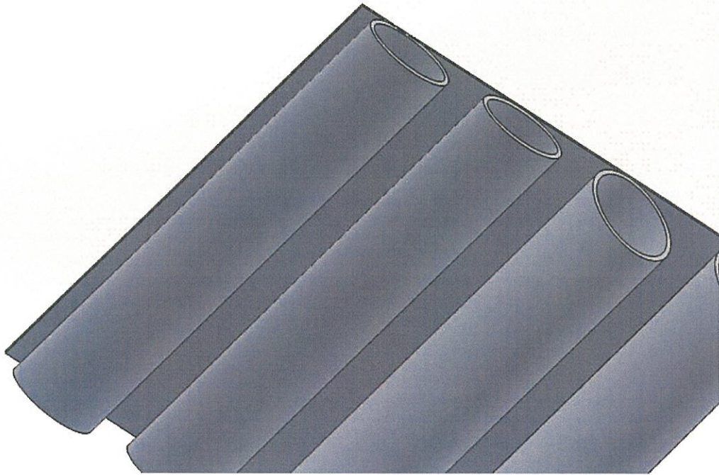
Şekil 44.Dairesel ve elips kesitli boruların plakaya teması (B).
