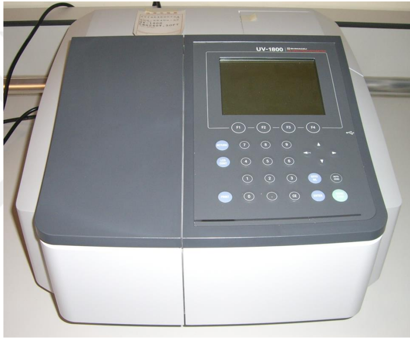
Resim 3.5 Doğrusal soğurma spektrometresi (Shimadzu UV-1800 foto, 2010)
