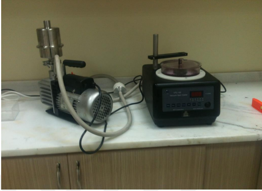
Resim 3.3 Laboratuvarımızda bulunan spin kaplama cihazı.
