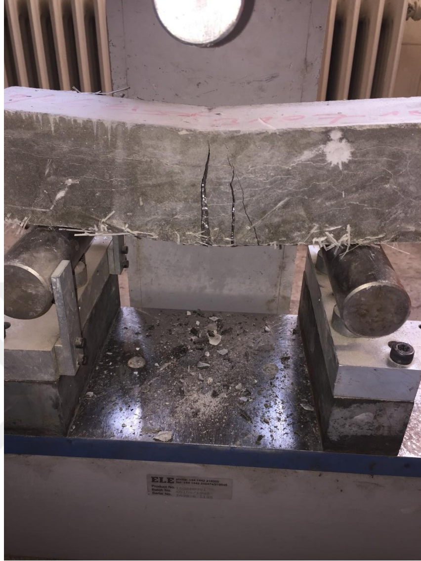
Şekil 3.5. Polipropilen liflerin numunedeki köprüleme işlevi
