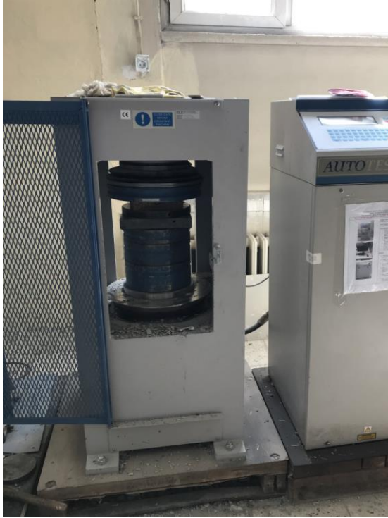
Şekil 2. 16.AOTOTEST 300 ton kapasiteli yükleme aleti
