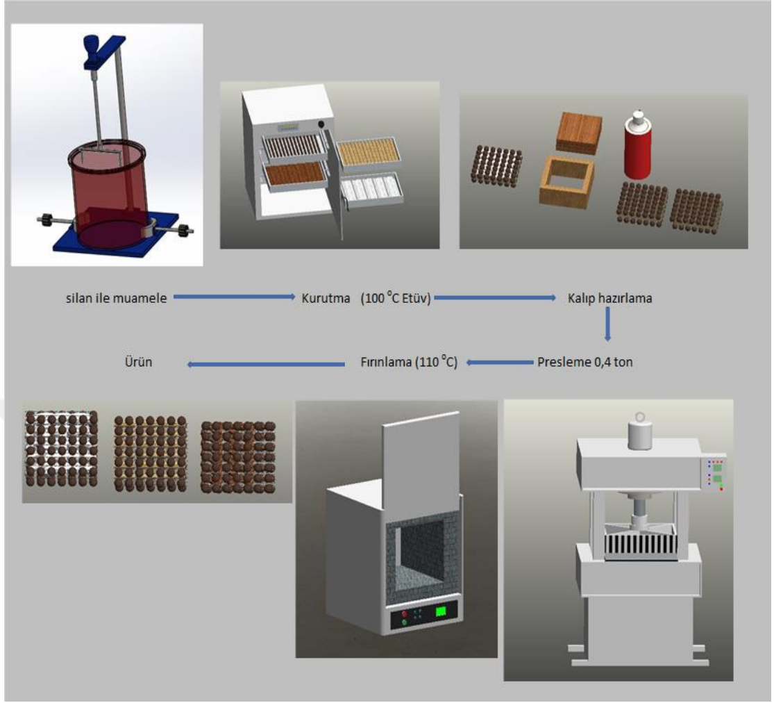
Şekil 2. 8. Üretim sisteminin akış şeması
