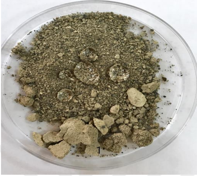
Şekil 3. 5. Hidrofobik kile dökülen suyun yakın görünümü
