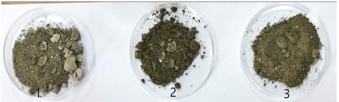
Şekil 3. 2. Hidrofobik hale getirilmiş kil numunelerine kile 2 ml su dökülmesi sonrası görünümleri
