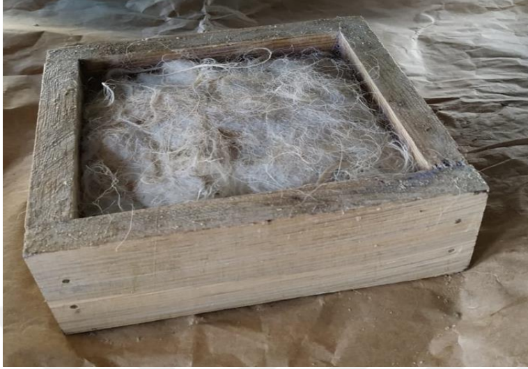
Şekil 2. 11. Kompozit üretiminde kullanılan kalıplar (kalıp boyutları 15cm x15 cm x7 cm dir)
