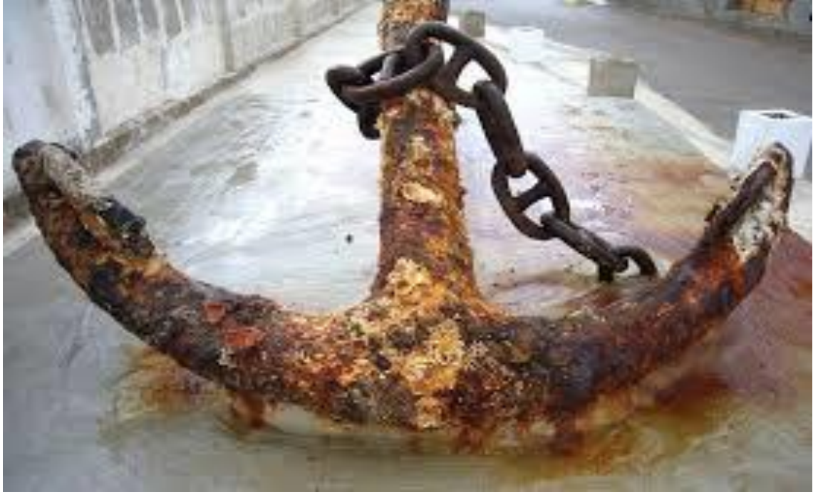
Şekil 1.1. Homojen korozyona maruz kalan çapa (URL-1 2016)
