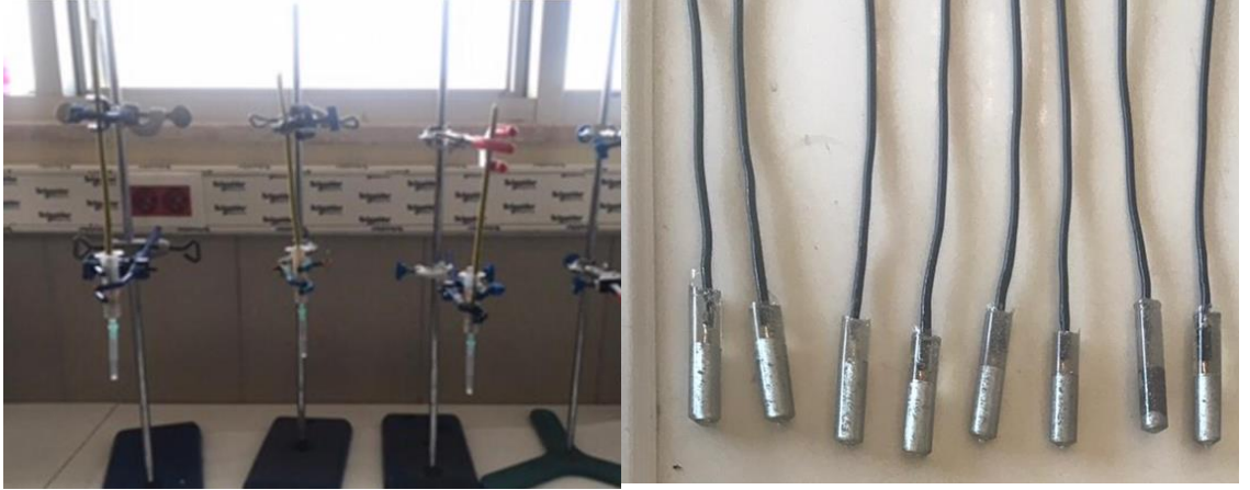
Şekil 2.7. Numunelerin yan alanlarının polimer kaplanması
