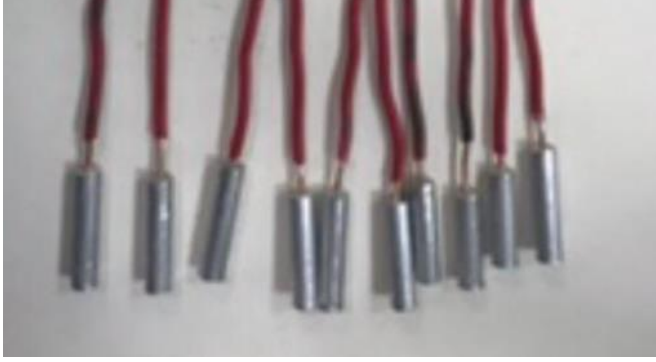
Şekil 2.6. Bakır tel geçirilmiş Al elektrotlar.
