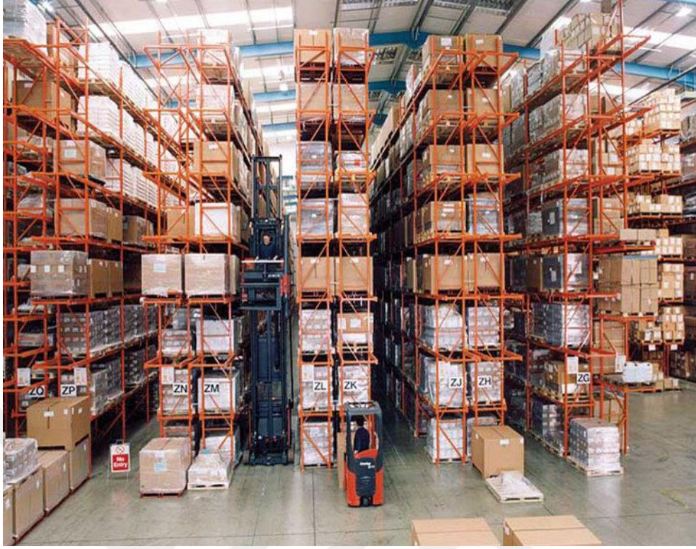
Şekil 16. Dar Koridorlu Depolama Sistemleri
