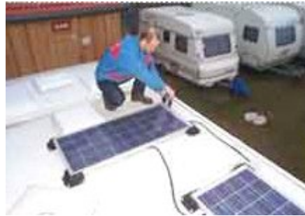
Şekil 3.15 Araç üstünde güneş pilinin kullanımı
