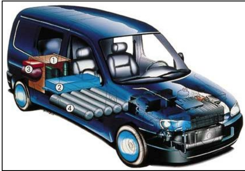
Şekil 2.2 CEA ve Endüstriyel Ortakları Tarafından Geliştirilen Yakıt Pili Prototip Araç
