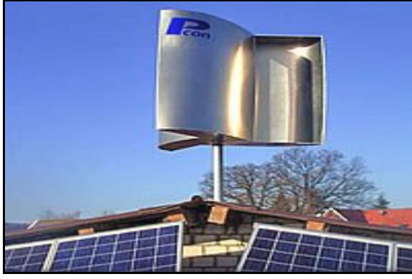
Şekil 2.1 Güneş Pilleriyle Birlikte Kullanılan Savonius Türbini
