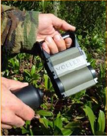
Şekil 2.14 Voller Energy Tarafından Geliştirilen Pil Şarj Cihazı Prototipi
