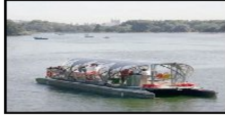
Sekil 2.10 Serpentine Solar Shuttle İsmindeki Güneş Enerjisi İle Çalışan Tekne
