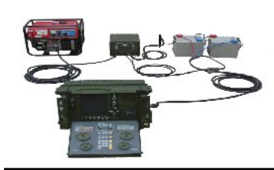
Şekil 3.11 ASKARAD'ta Kullanılan Güç Sistemi Bağlantıları
