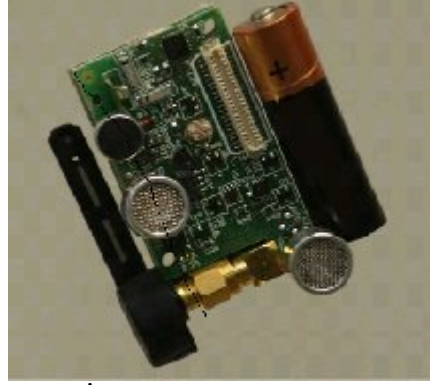
Şekil 3.8 İşlemci ve RF Modülü, Düğüm RF
