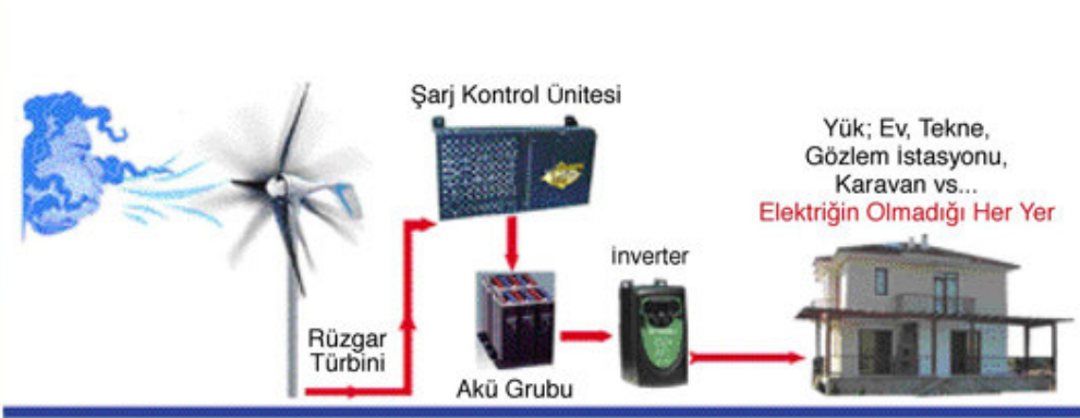
Şekil 1.8 Rüzgar Enerjisi Üretim Sisteminin Çalışma Prensipleri
