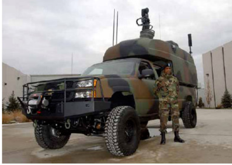
Şekil 5.9 General Motors Firmasının 5 kW'lık Yakıt Hücreli Taşıtı (Crawley, 2007).
