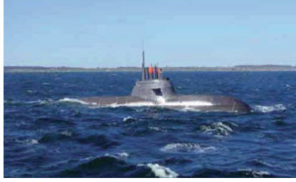
Şekil 5.7 Almanya'nın Yakıt Pili Kullanan İlk Denizaltısı 2003 Yılında Test Edilirken (Crawley, 2007).
