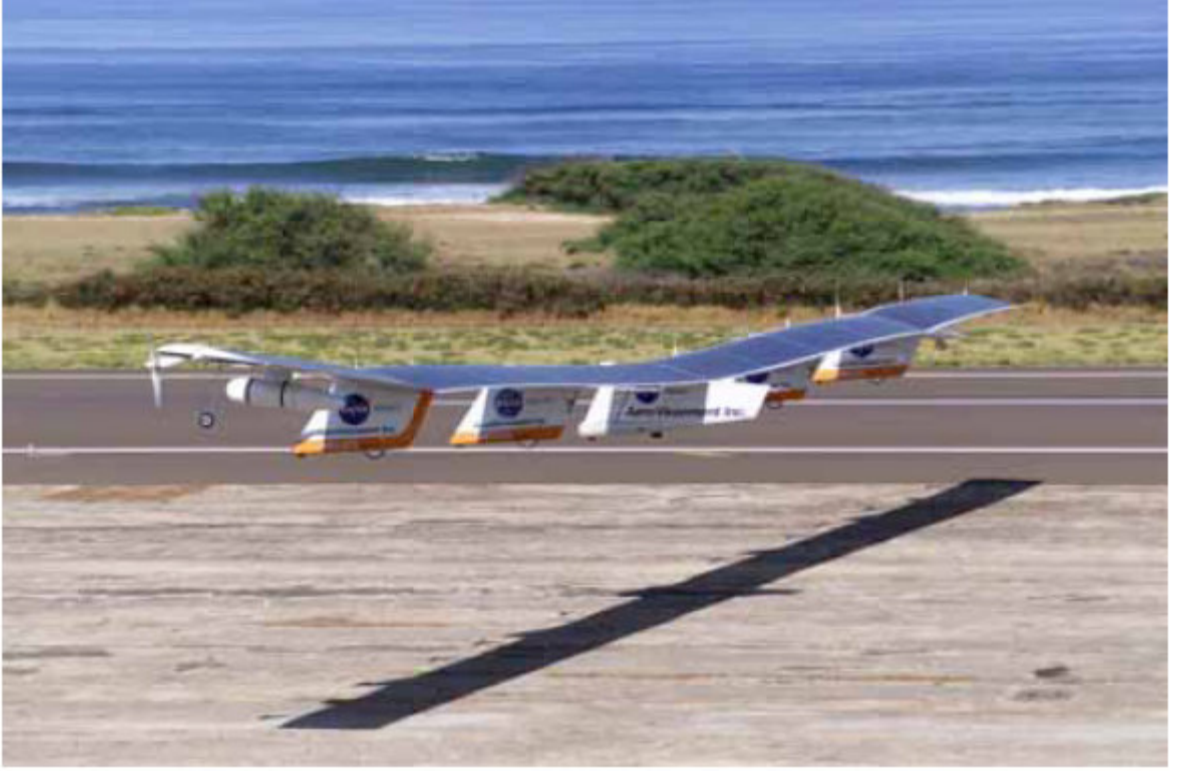
Şekil 5.10 NASA Tarafından Geliştirilen Yakıt Piliyle Çalışan İnsansız Hava Aracı (UAV) Örneği (Geiger, Jollie, 2004).
